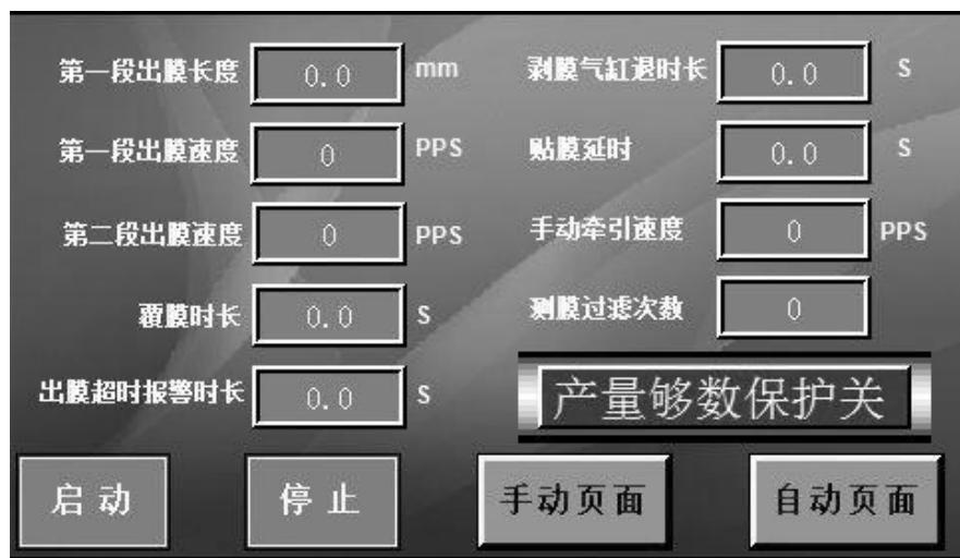
**手动牵引速度：**点击可进行输入，当前数字为手动操作是，牵引电机的脉冲频率。
